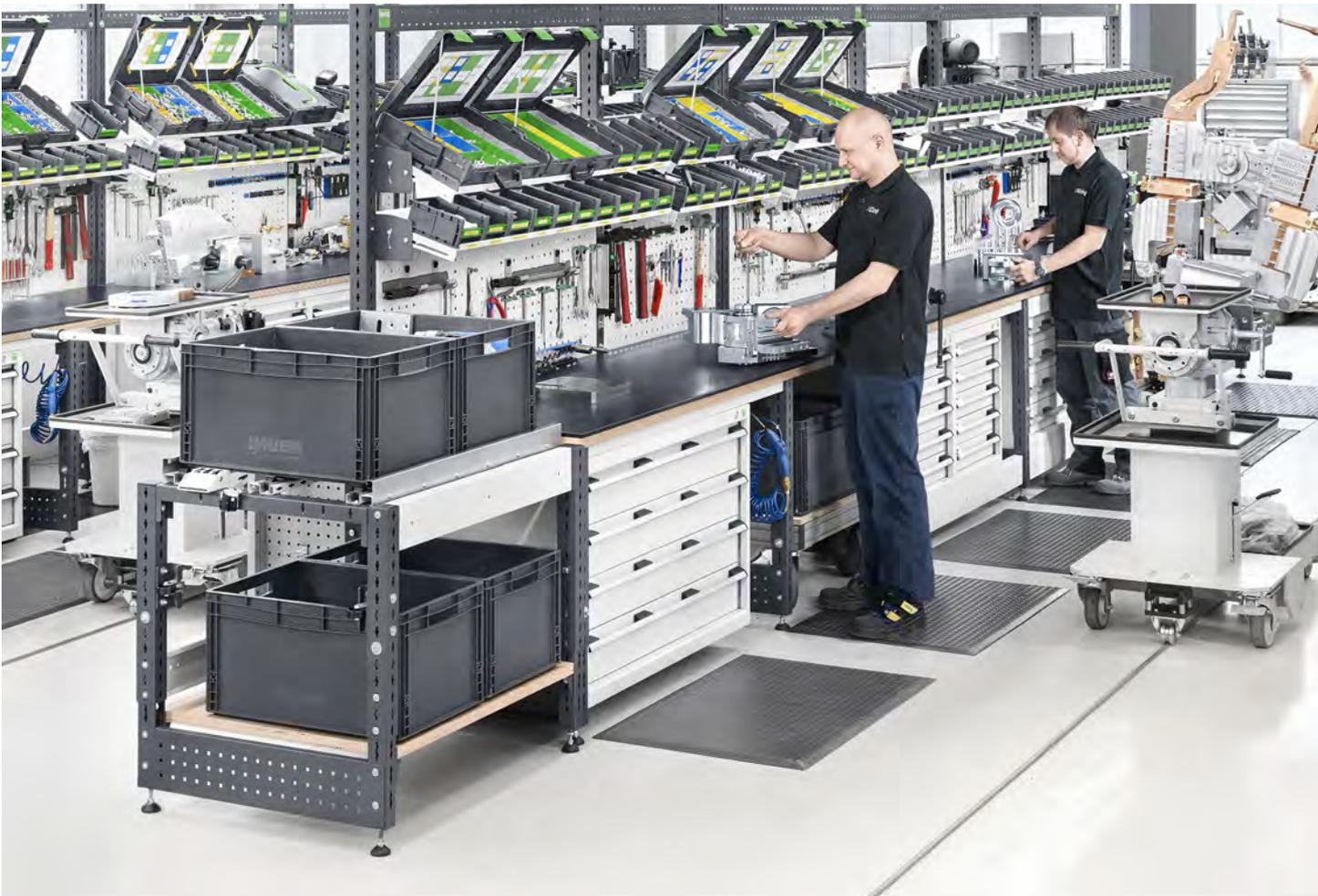
bott Mehrplatzsysteme verbinden mehrere Arbeitsplätze schnell und einfach zu Montagelinien. Beim Einsatz von Erweiterungsmodulen werden Bauteile eingespart. Der modulare und stabile Aufbau mit frei kombinierbaren Einheiten bietet auch die Möglichkeit für eine doppelseitige Montage. Wird die gleiche Montageline an der Rückseite angebaut, können bis zu 40% der Anschaffungskosten eingespart werden.
